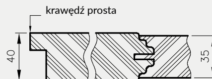
Przekrój poziomy drzwi Scala, Berge
