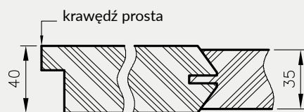
Przekrój poziomy drzwi Elsa
