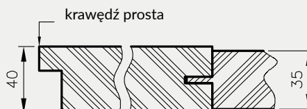
Przekrój poziomy drzwi Scala, Berge
