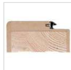
OŚCIEŻNICA STAŁA drewniana dla R_w=32 dB i R_w=39 dB lub z MDF dla R_w=30 dB
