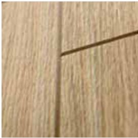
zbliżenie na frezowanie - widoczna struktura dębu naturalnego
